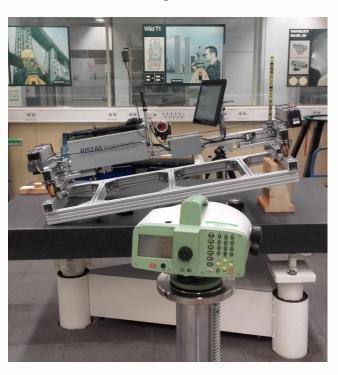
Projektbegleitend kann vor Ort eine Systemkalibrierung mit Hilfe einer speziellen Rahmenkonstruktion durchgeführt werden, welche zuvor mit dem Lasertracker Leica AT901-LR referenziert wurde. Spezielle Adaptierungen ermöglichen dabei den Einsatz von Barcode-Nivellierlatten zur Überprüfung des Neigungsgebers bei Neigung des Rahmens.
