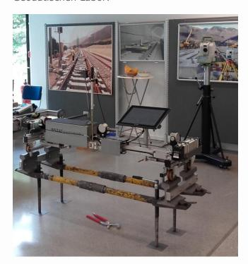
Der Operateur steuert den interaktiven Messprozess über ein Touchscreen-Display. Die Software der GML kommuniziert über eine offene Schnittstelle mit der parallel laufenden Trassierungssoftware, welche die Soll-Geometrie der abzusteckenden Trasse bereitstellt. Für den Betrieb des Messsystems ist grundsätzlich nur eine Person erforderlich, lediglich für den Transport werden zwei Personen benötigt.
